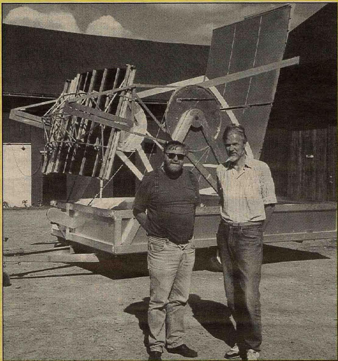
Prototypen av solkoncentratorn finns nu i två storlekar. Tomas Elofsson och Ambjörn Naeve poserar här stolt framför det större exemplaret som är monterat på en släpkärra.
